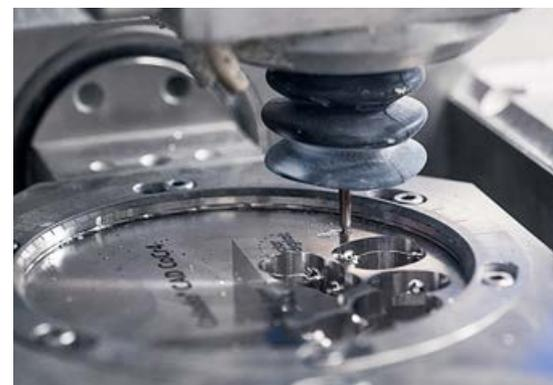
**Fräsen.** Eine vollautomatische Metallfräse schneidet nach den Daten aus dem CAD-Programm die Krone zu.
